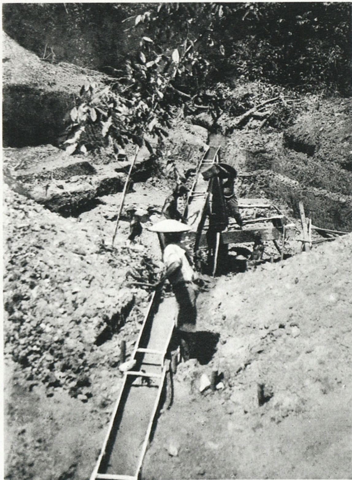
LAVAGE D'ALLUVIONS AURIFÈRES DANS UN SLUICE, PAR DES CHERCHEURS D'OR ISOLÉS.
