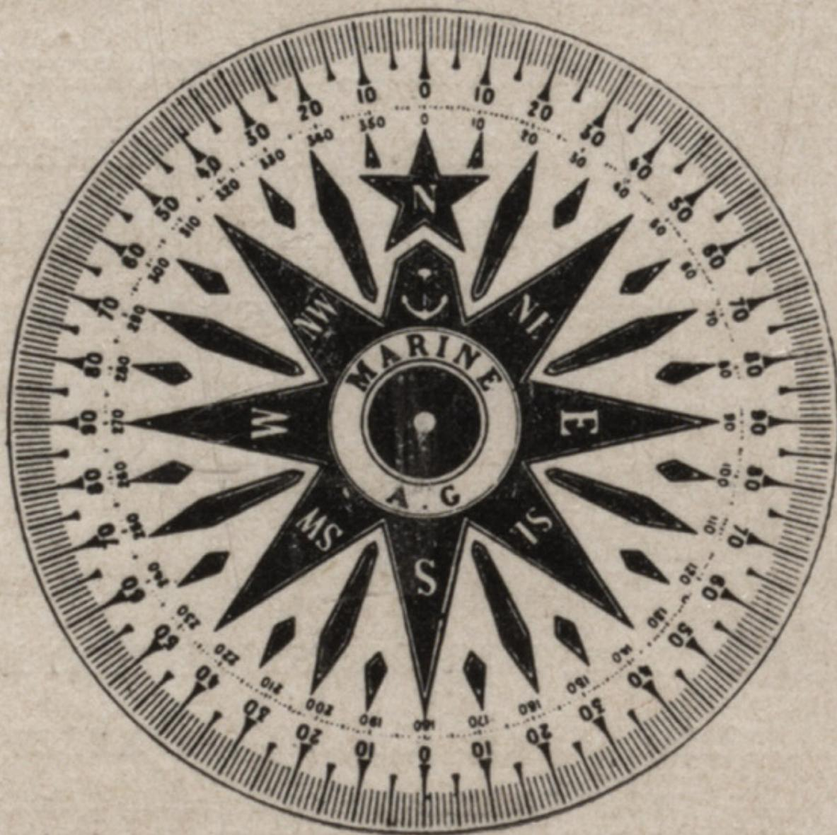
La carte d'un compas de vapeur. Les divisions, pour donner plus de précision, vont de  $0^\circ$  à  $90^\circ$  en partant du N. et du S., et aussi de  $0^\circ$  à  $360^\circ$  en partant du N., dans le sens des aiguilles d'une montre.
