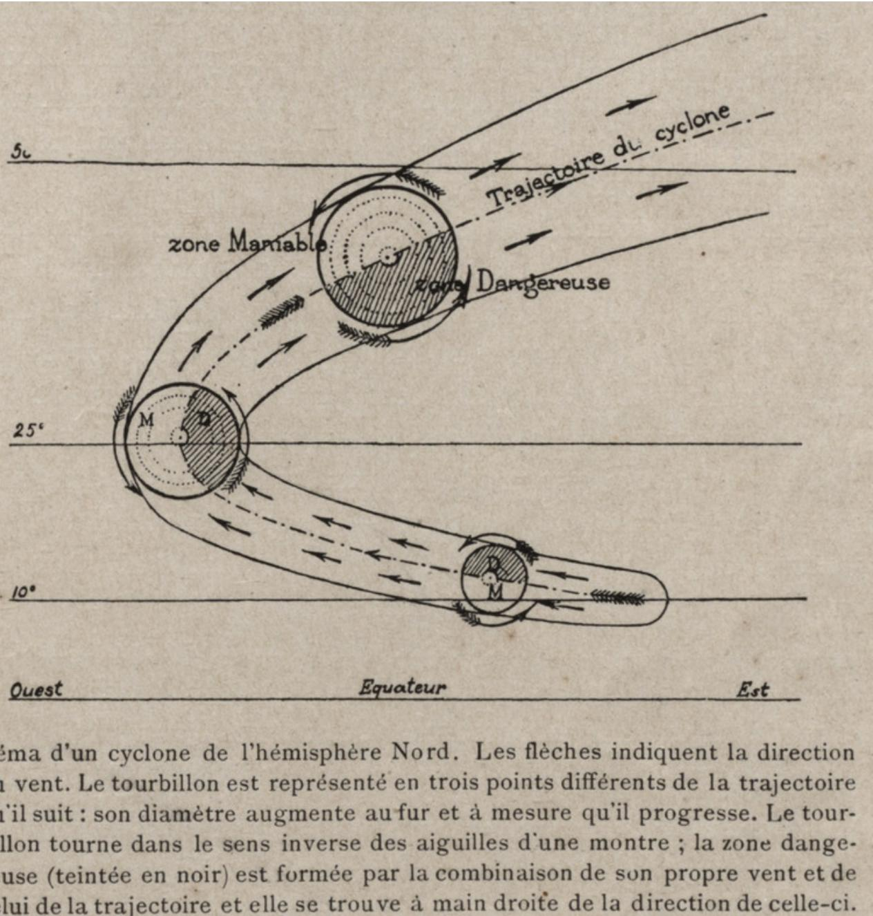
Schéma d'un cyclone de l'hémisphère Nord. Les flèches indiquent la direction du vent. Le tourbillon est représenté en trois points différents de la trajectoire qu'il suit : son diamètre augmente au fur et à mesure qu'il progresse. Le tourbillon tourne dans le sens inverse des aiguilles d'une montre ; la zone dangereuse (teintée en noir) est formée par la combinaison de son propre vent et de celui de la trajectoire et elle se trouve à main droite de la direction de celle-ci.
