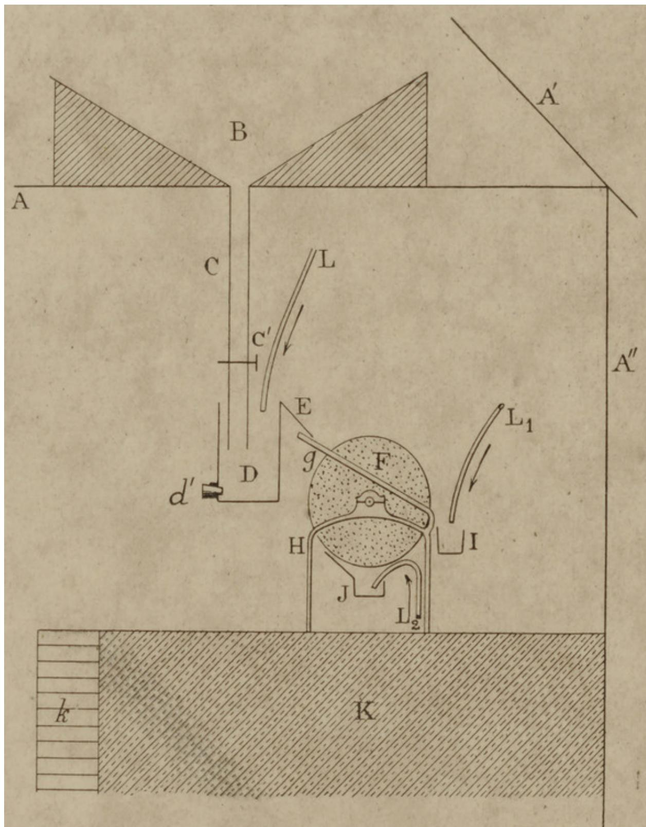
Fig. 24. — Schéma d'une installation type de dépulpeur.
