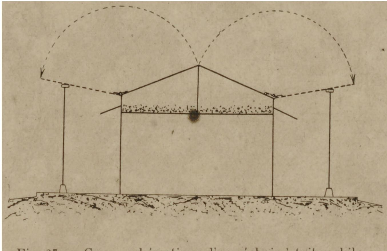
Fig. 27. — Coupe schématique d'un séchoir à toit mobile.
