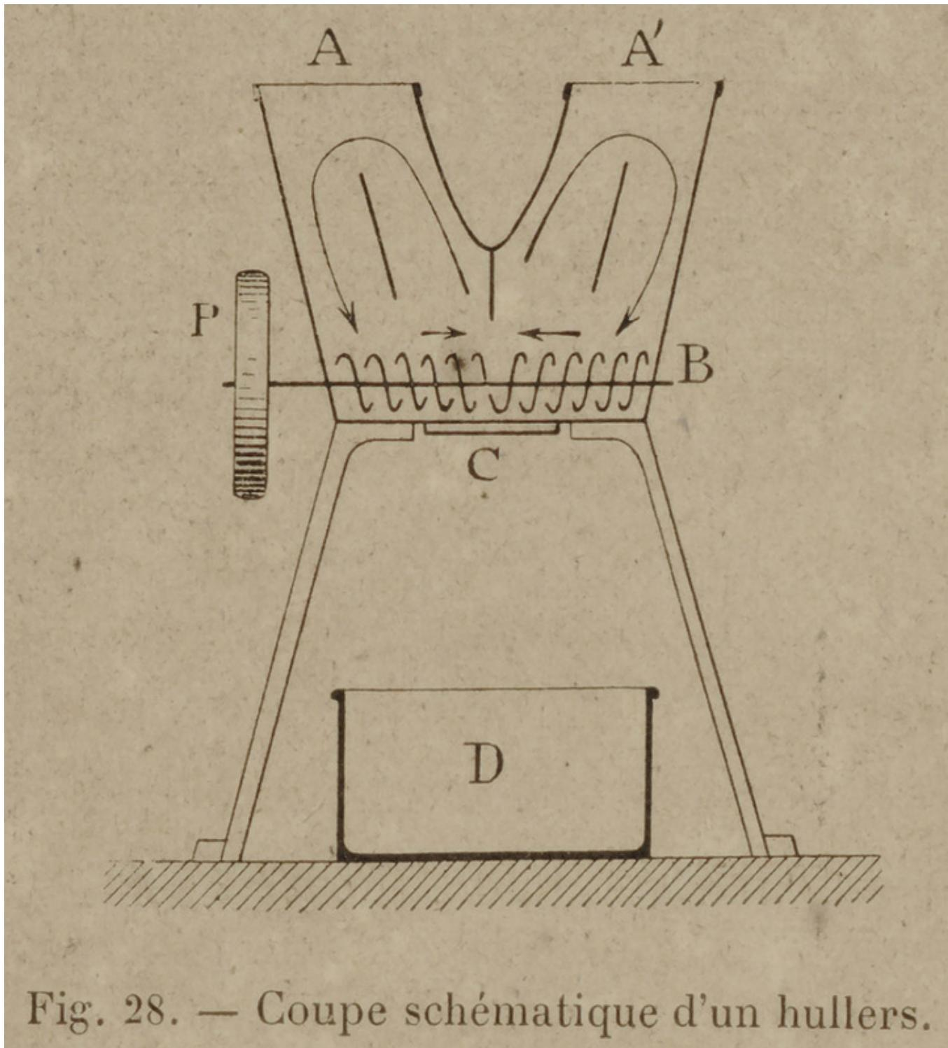
Fig. 28. — Coupe schématique d'un hullers.
