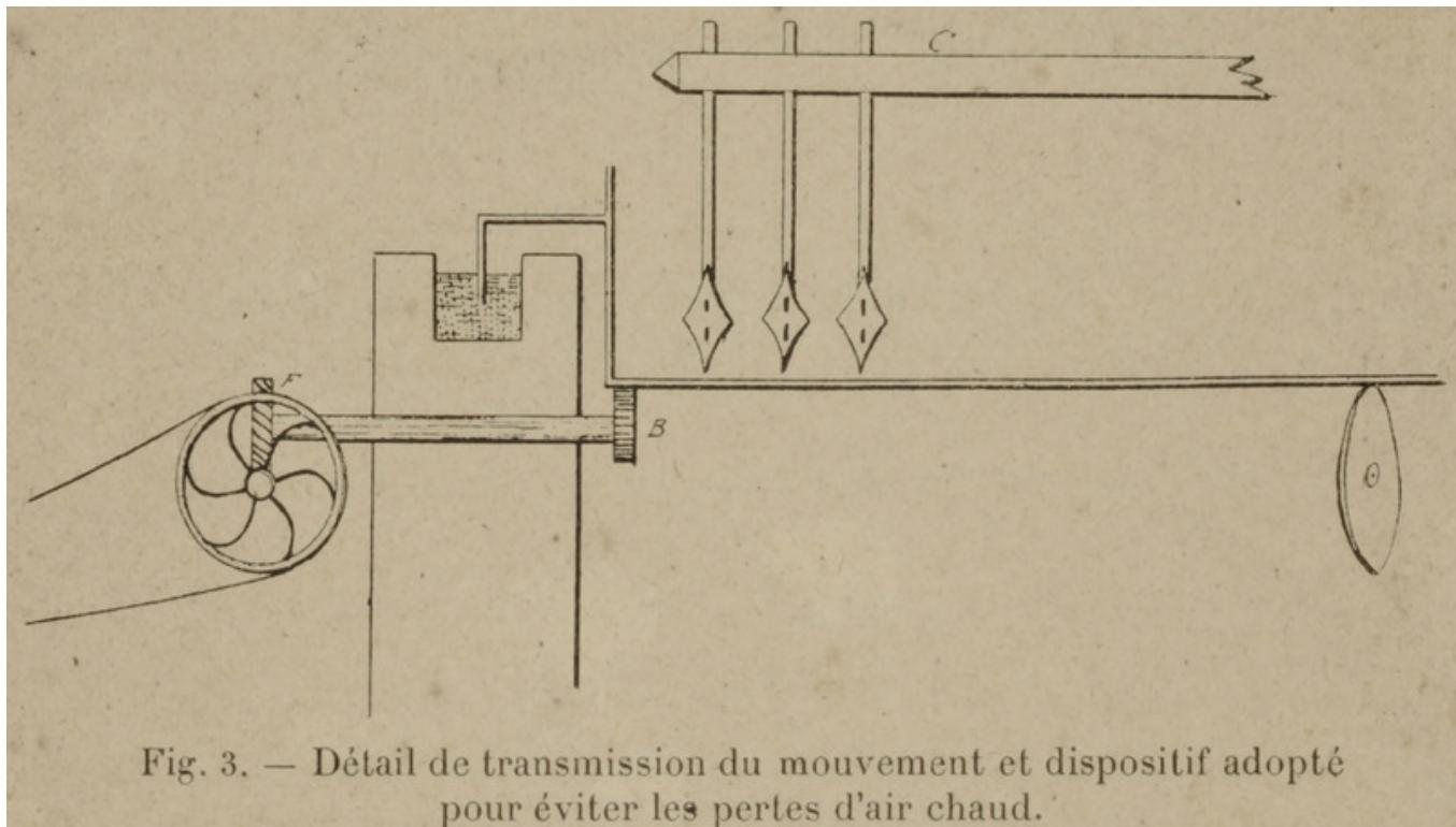
Fig. 3. — Détail de transmission du mouvement et dispositif adopté pour éviter les pertes d'air chaud.
