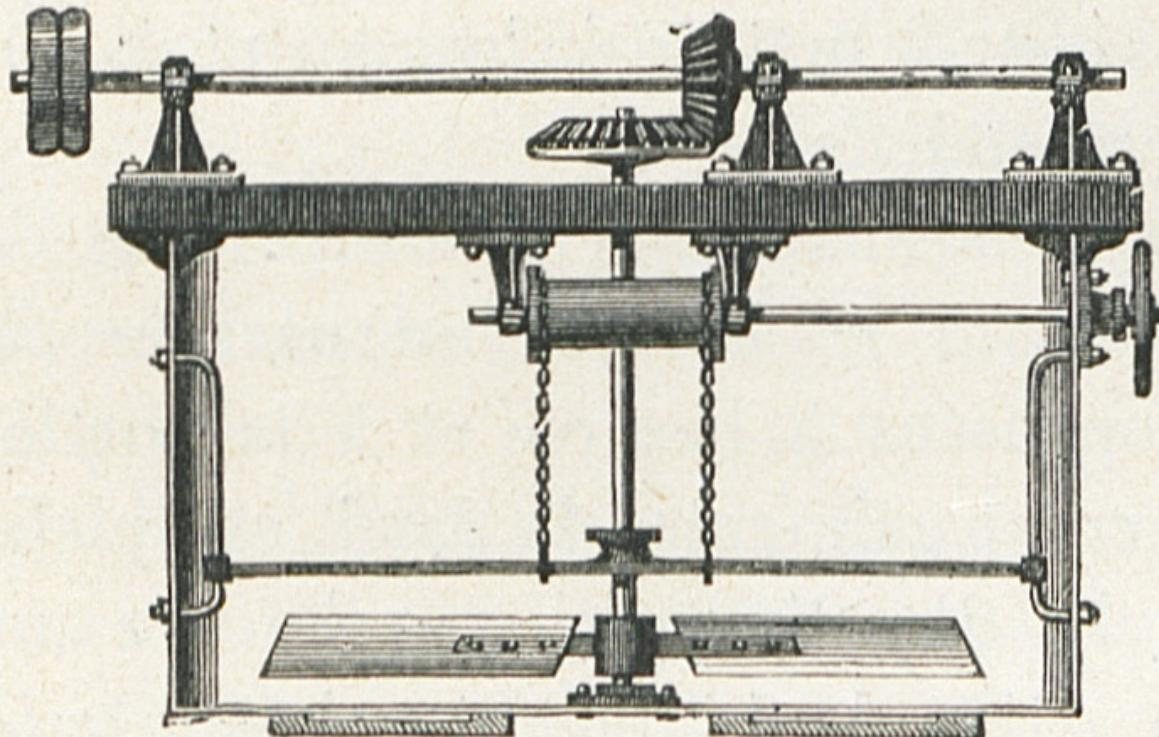
FIG 45. — Mécanisme des démêleurs.
