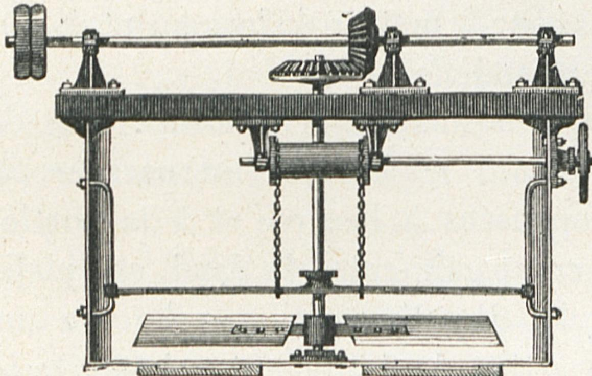
FIG 45. — Mécanisme des démêleurs.
