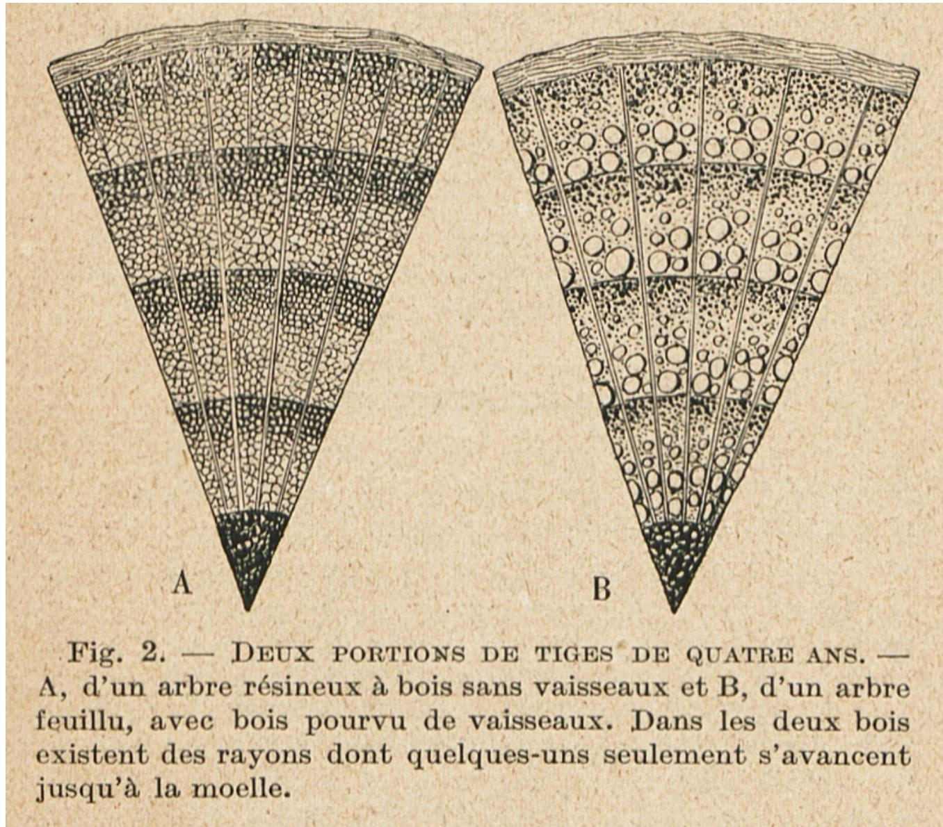
Fig. 2. — DEUX PORTIONS DE TIGES DE QUATRE ANS. — A, d'un arbre résineux à bois sans vaisseaux et B, d'un arbre feuillu, avec bois pourvu de vaisseaux. Dans les deux bois existent des rayons dont quelques-uns seulement s'avancent jusqu'à la moelle.
