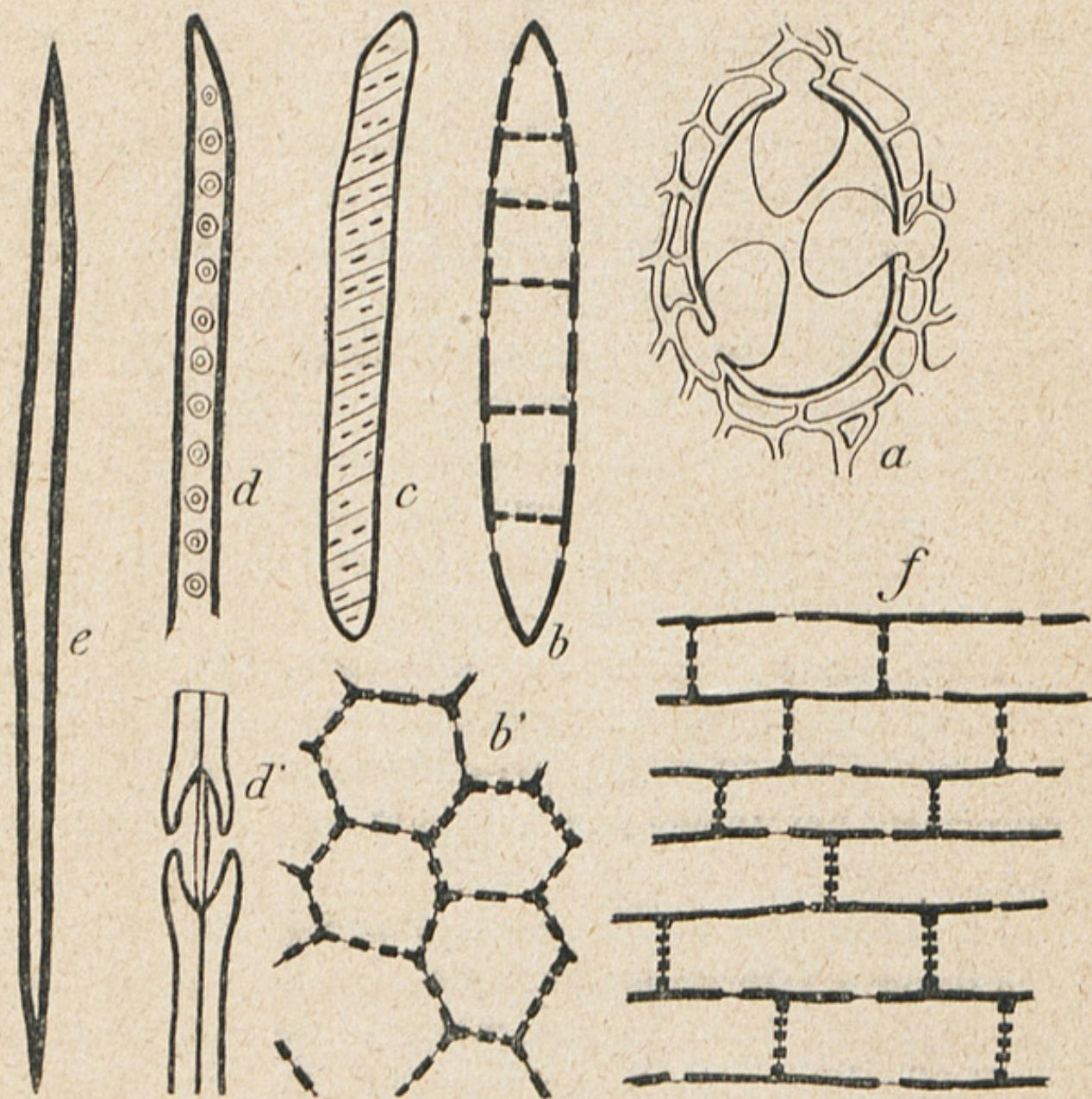
Fig. 4. — TRACHÉIDES ET FIBRES. — *a*, section d'un vaisseau envahi par les thylles; *b*, *b'*, parenchyme ligneux; *c*, trachéide à ponctuations simples; *d*, trachéide à ponctuations aréolées; *d'*, une de ces ponctuations vue en coupe; *e*, une fibre ligneuse; *f*, éléments constituant un rayon du bois, avec des ponctuations plus nombreuses sur les cloisons verticales tangentialles.
