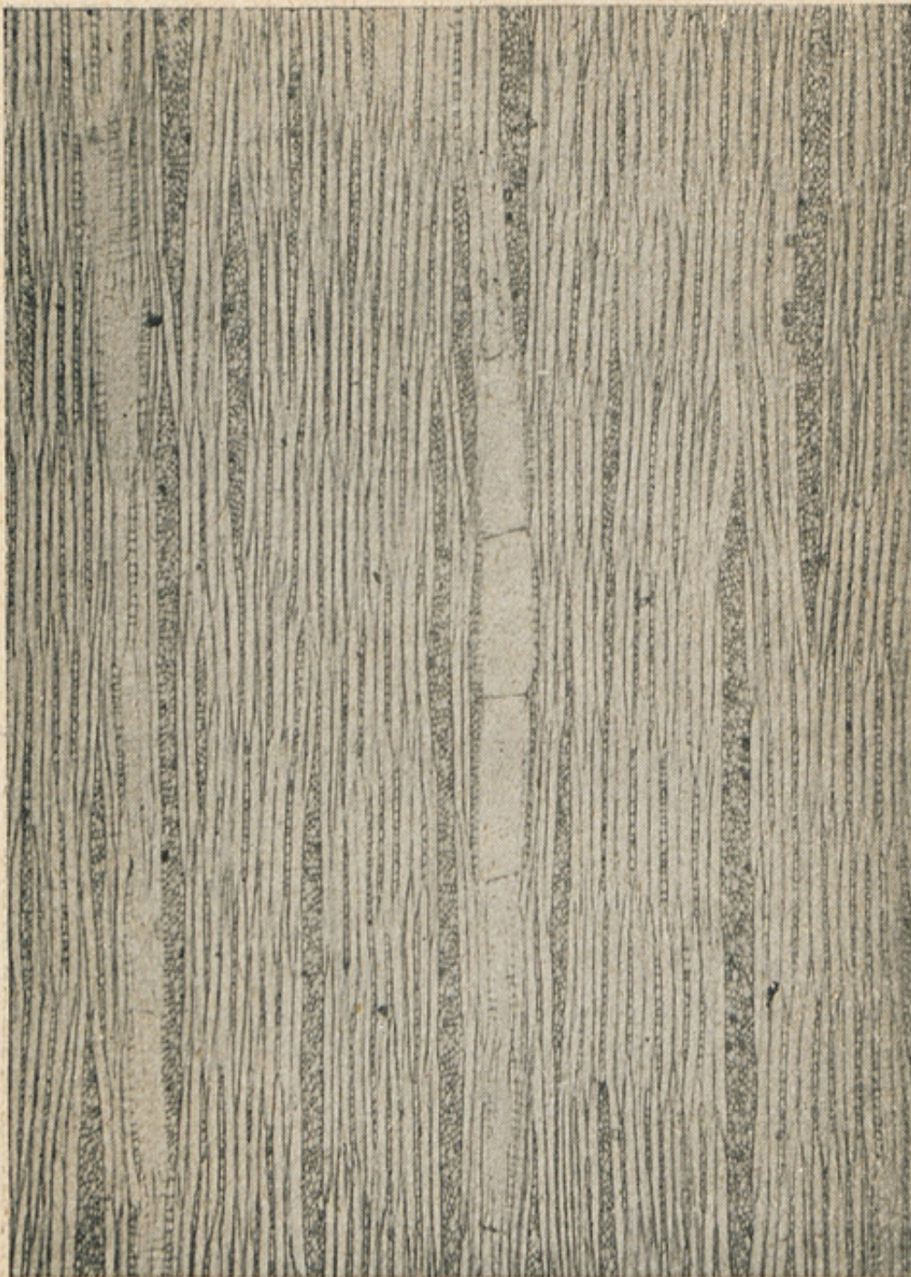
Fig. 23. — SECTION LONGITUDINALE TANGENTIELLE DE BOIS DE Columbia Thorelii G. (Tiliacées) avec rayons de deux sortes, les petits, plus ou moins étagés. (Grossiss t : 30 diam.)
